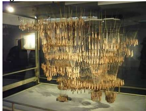
Figure 1 Upside Down Model of Sagrada Família
